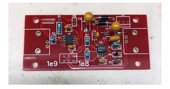
$C_3, C_4, C_5, C_6^- 0.1 \ \mu F$  $C_7^- 100 \ p F$
